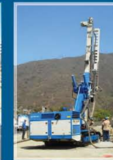
Micropilotes Diámetro: 115 - 300 mm Profundidad max.: 100 mts.
