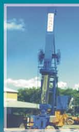
MAQUINA PILAS OBLONGAS Y MUROS COLADOS
