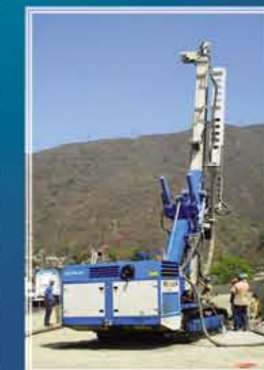
Micropilotes Diámetro: 115 - 300 mm Profundidad máx.: 100 mts.
